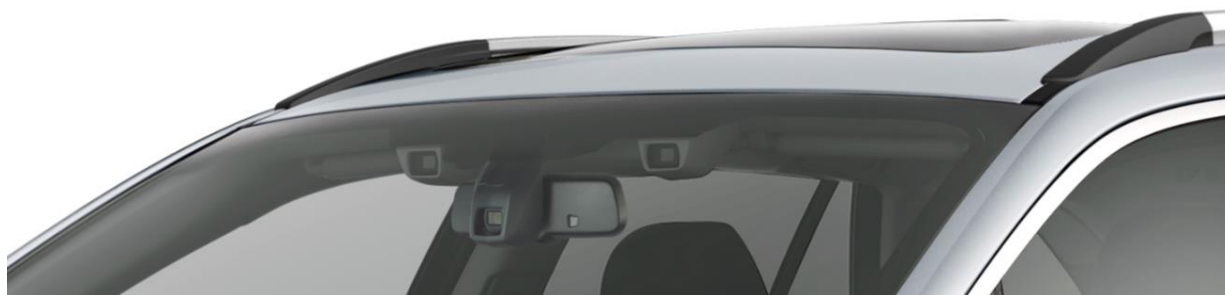
Sistema EyeSight con telecamera stereo
